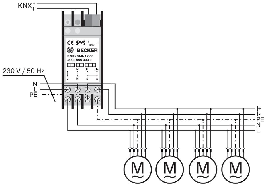
Zentralsteuerung von bis zu 8 Antrieben möglich
