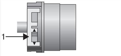
**i** Ein ändern der Drehrichtung ist nur möglich, wenn keine Endlagen eingestellt sind. Gegebenenfalls müssen zur Drehrichtungsänderung beide Endlagen gelöscht werden.
