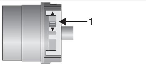
Schieben Sie den Drehrichtungsschalter (1) in die gegenüberliegende Position.
